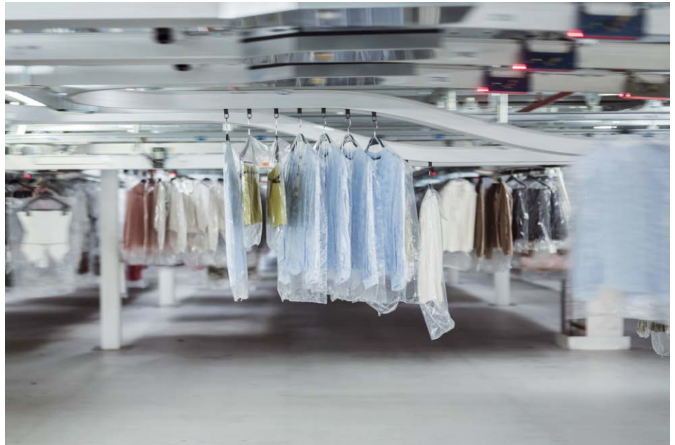
Adapter-Hängeförderer mit RFID-Erkennung.
