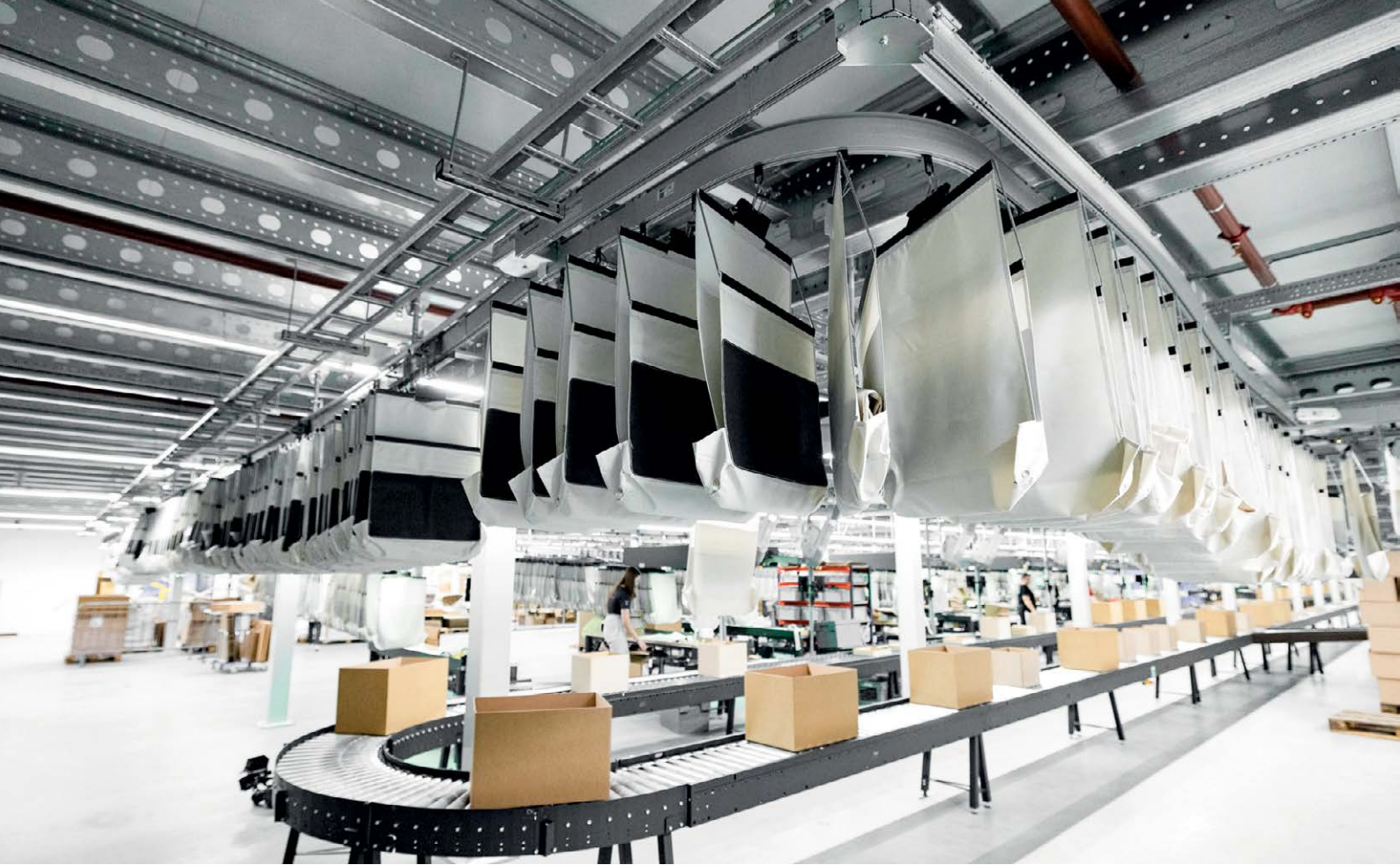
Bei Modexpress wird die Multi-Client-Sortierung mit der EcoPocket von DFT umgesetzt.
