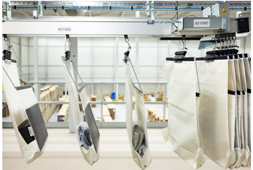
EcoPocket-Technologie: ein Taschensorter-System mit intelligenter Adapter- und Sortierlogik.
