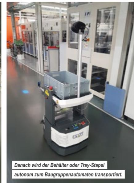
Danach wird der Behälter oder Tray-Stapel autonom zum Baugruppenautomaten transportiert.
