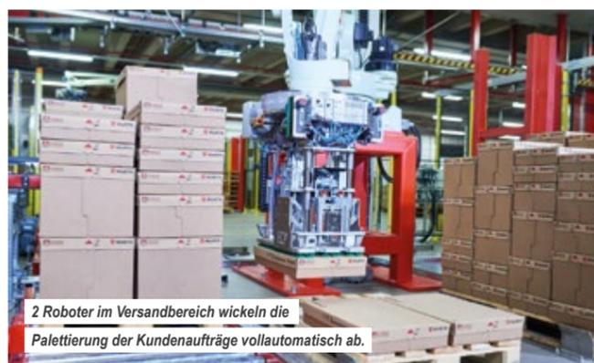
2 Roboter im Versandbereich wickeln die Palettierung der Kundenaufträge vollautomatisch ab.
