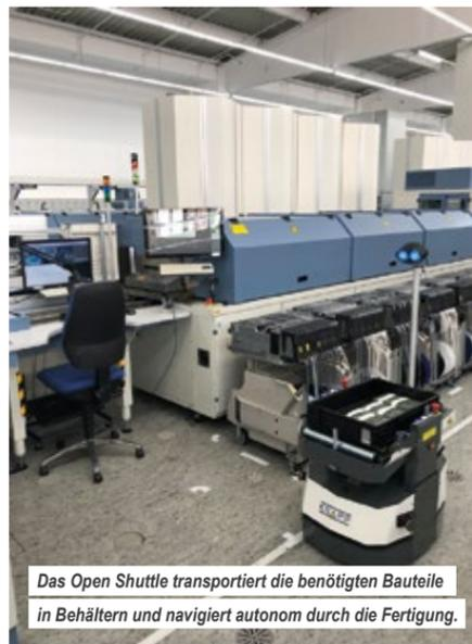
Das Open Shuttle transportiert die benötigten Bauteile in Behältern und navigiert autonom durch die Fertigung.
