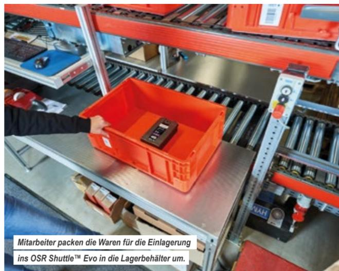
Mitarbeiter packen die Waren für die Einlagerung ins OSR Shuttle™ Evo in die Lagerbehälter um.
