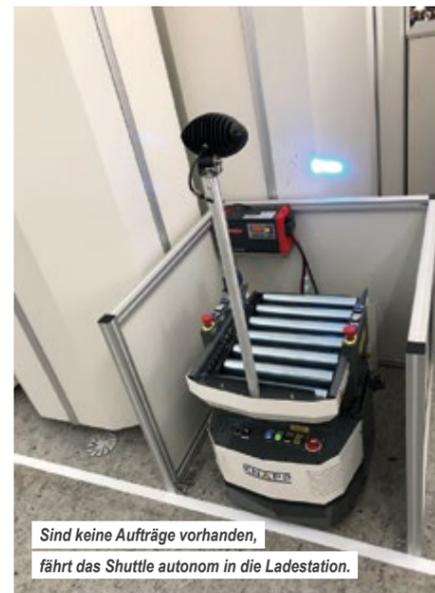
Sind keine Aufträge vorhanden, fährt das Shuttle autonom in die Ladestation.
