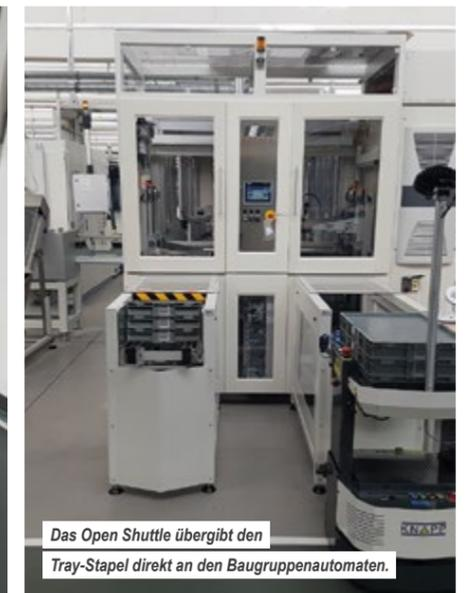
Das Open Shuttle übergibt den Tray-Stapel direkt an den Baugruppenautomaten.
