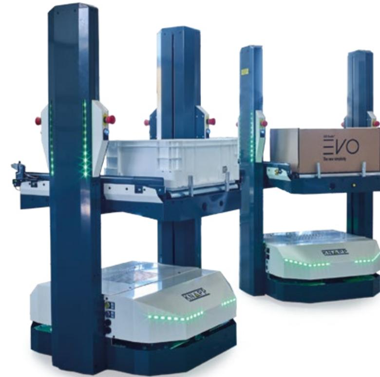
Die CE zertifizierte Lösung, bestehend aus dem Basisfahrzeug Open Shuttle und den möglichen Lastaufnahmemitteln (LAM), wird in Österreich produziert. Eine Auswahl an LAM ermöglicht den Transport von Behältern, Kartons, Trays, Magazinen uvm.
