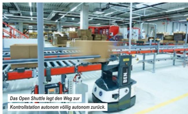
Das Open Shuttle legt den Weg zur Kontrollstation autonom völlig autonom zurück.
