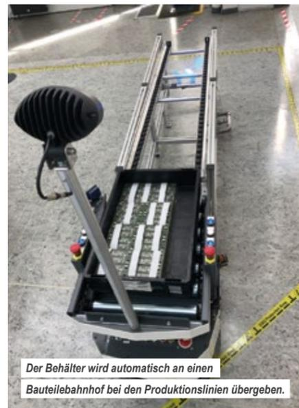
Der Behälter wird automatisch an einen Bauteilebahnhof bei den Produktionslinien übergeben.
